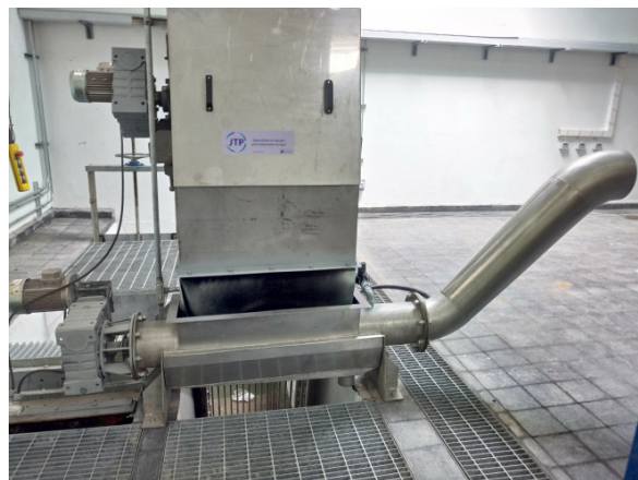
Diseño y fabricación de reja automática de cadena y tornillo compactador para para proyecto “Planta Guayacan, Coquimbo”. Cliente: Aguas del Valle
