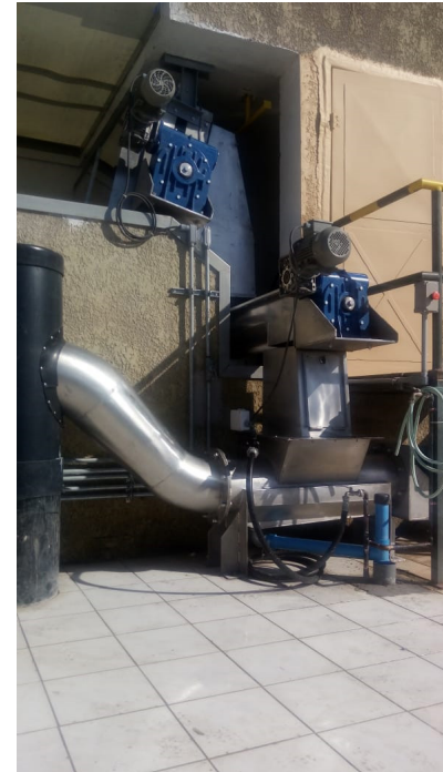
Diseño y fabricación de sistema de retiro, transporte y compactación de sólidos para proyecto “Emisario Coquimbo”. Cliente: Aguas del Valle.
