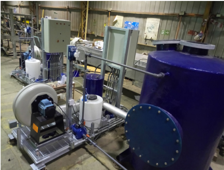
Diseño y fabricación de Biofiltro para proyecto “PTAS Arequipa”, Perú.
