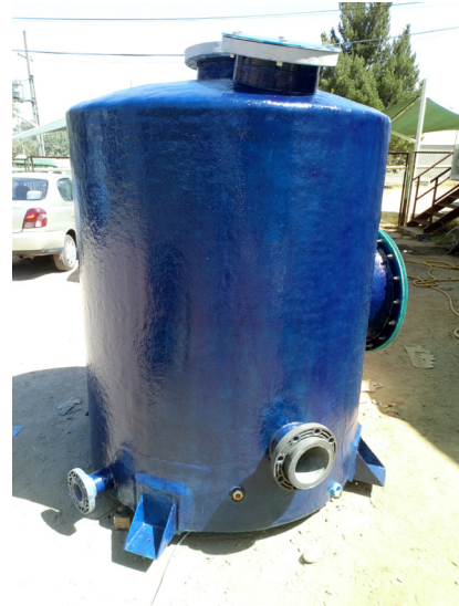
Diseño y fabricación de Filtro de Olores para proyecto “ Pozo vía Brasil”, Panamá.
